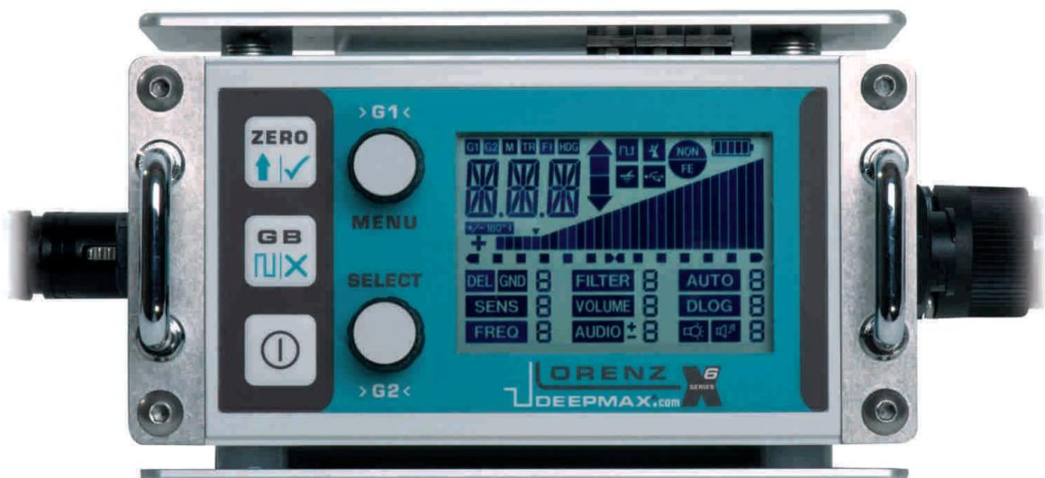
signalisieren, dass der Bediener nicht auf der Spurgeraden läuft und sich etwas rechts halten soll, bis die beiden Kästchen verschwinden. Zusätzlich kann die Richtung auch mit der **HDG** Heading = Kompassanzeige in Grad angezeigt werden. Es sollte bei jeder Spur die gleiche Anzeige vorkommen, wobei einige Meter abgelaufen werden müssen um eine brauchbare Anzeige zu generieren.
